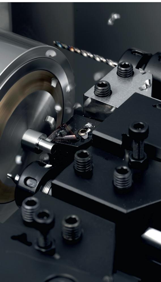
1 Maschinen von Citizen Machinery mit LFV-Technologie sorgen mit ihrer speziellen Steuerungstechnik für einen kontrollierten Spanbruch bei schwer zerspanbaren Werkstoffen. Kombiniert mit dem für hohe Präzision konzipierten Maschinenaufbau der L- und GN-Serie eröffnet diese Technologie ganz neue Möglichkeiten in der Bearbeitungstechnologie
